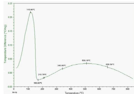
Figura 3. Curva de DTA obtenida para el gel intermedio de sílica.
