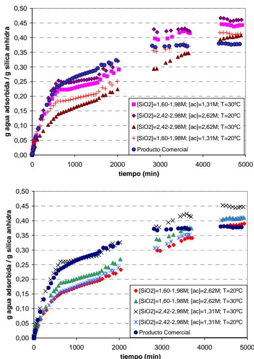
Figura 4. Curvas de adsorción de humedad a condiciones de Bogotá (65% HR, T = 20°C promedio). [SiO<sub>2</sub>]=Concentración del SiO<sub>2</sub> en el silicato de sodio; [ac]=Concentración de H<sub>2</sub>SO<sub>4</sub>; T=temperatura de reacción.
