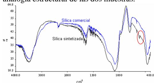
Figura 6. Comparación del espectro infrarrojo para la SGA sintetizada y la sílica comercial. Se resalta el pico correspondiente a  $\text{SO}_4^{=}$ .
