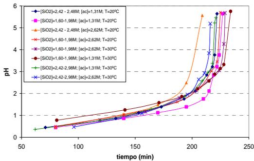
Figura 1. Seguimiento del pH en función del tiempo durante la etapa de reacción. [SiO<sub>2</sub>]=Concentración del SiO<sub>2</sub> en el silicato de sodio; [ac]=Concentración de H<sub>2</sub>SO<sub>4</sub>; T=temperatura de reacción.
