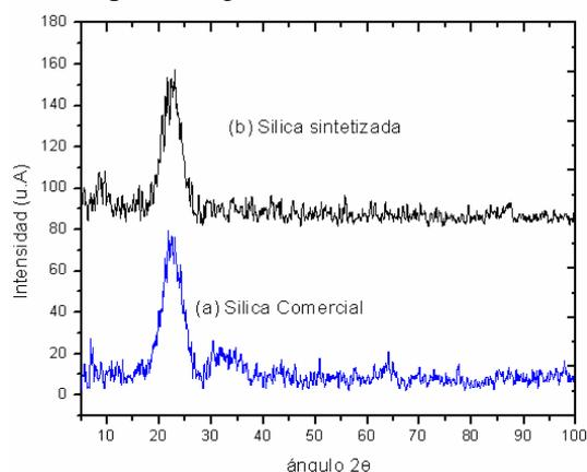
Figura 5. Difracción de rayos X para una muestra de sílica comercial y la SGA sintetizada con:  $[\text{SiO}_2]= 1.60\text{-}1.98\text{M}$ ;  $[\text{ac}] = 1.31\text{M}$ ;  $T=30^\circ\text{C}$  (las intensidades se reportan en unidades arbitrarias, por tanto es indiferente la línea base)
