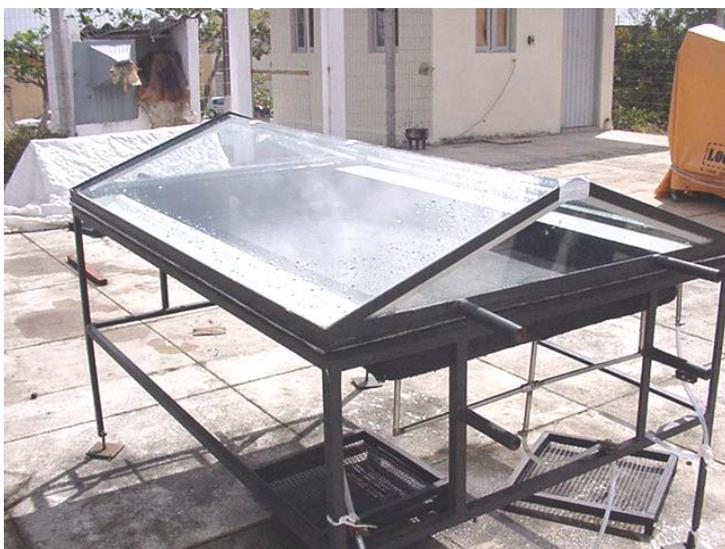
Figura 1: Destilador solar com cobertura de 20°
