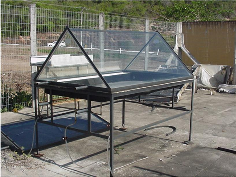
Figura 2: Destilador solar com cobertura de 45°
